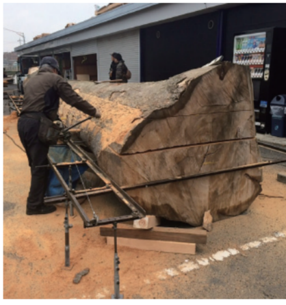
※3、櫟(けやき)の原木の切出し作業の様子
